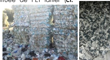
Photographies 1 et 2. Paillettes de PET opaque testées dans la fabrication de mousses PET
