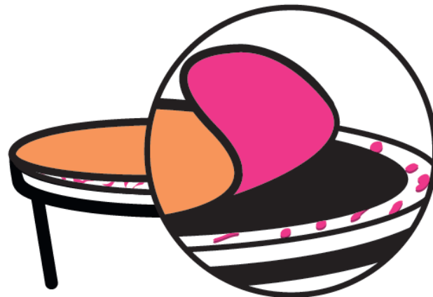
Opercule pelable Pelabilité adhésive
