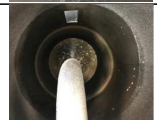
La matière colle avant d'arriver dans l'extrudeuse
