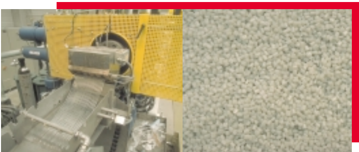
Le PET est extrudé en joncs qui sont ensuite coupés en granulés
